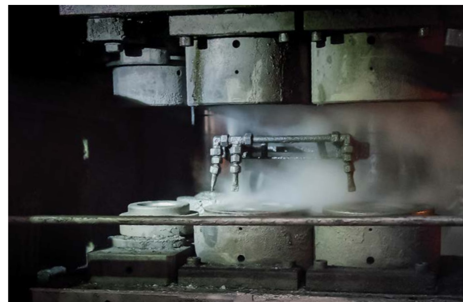
Robot je umiestnený za lisom. Počas kovania vysunie rameno nad kovacie náradie a vystrekne naň stanovené množstvo mazadla. Robí to vždy rovnakým tempom. Aj preto je takéto mazanie najefektívnejšie.
