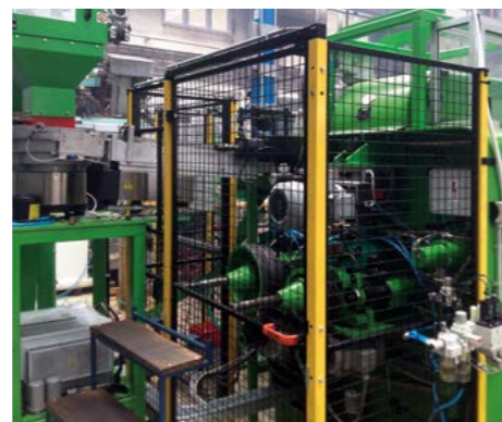
Stroj Gnutti je po generálnej oprave, robot ABB spoločne s vibračným zásobníkom je kompletne nový. Pochádza z Talianska.
